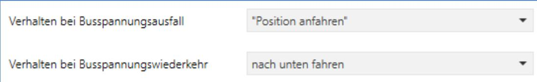
Abbildung 11: Verhalten bei Busspannungsausfall/-wiederkehr
